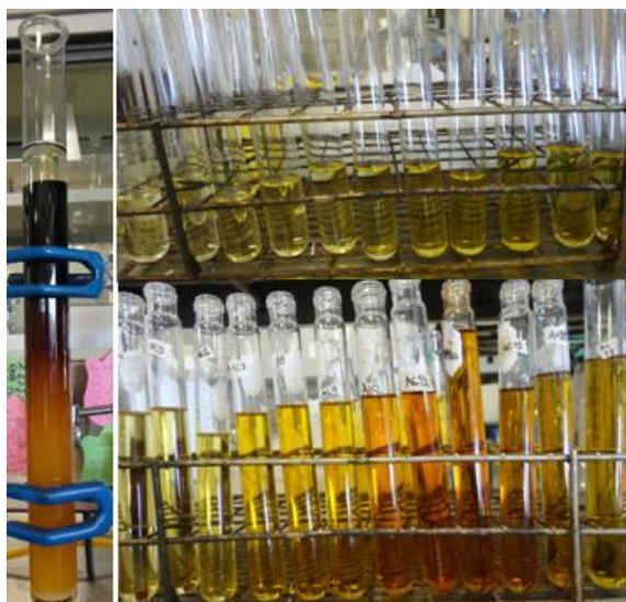
Figura 27. Fraccionamiento por columna abierta del extracto crudo obtenido de H1 en medio líquido
