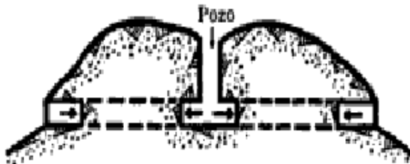
Fig. 3.1.3.5 Túnel con cuatro frentes de ataque Referencia Bibliografica: Paul Galabru (1974), Cimentaciones y túneles, publicado por reverté, España, Pag. 290.
