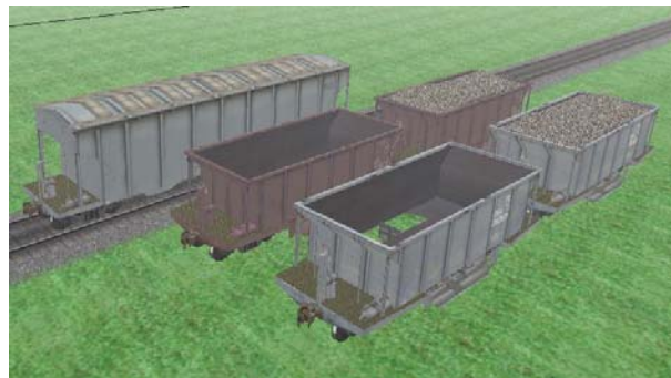
Fig.10.3: Tolvas con compuertas en el inferior y en los costados permitiendo así esparcir material en los extremos y en el centro de la vía en forma simultánea
