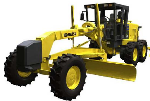
Fig. 10.1. Máquina con bastidor metálico montado sobre llantas neumáticas con pala raedera utilizado para empuje de tierras y relleno de depresiones con objeto de nivelar terreno.
