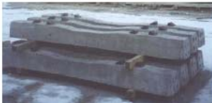
Fig. 3.7.13. Durmientes de hormigón.
