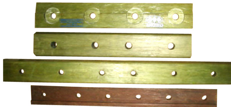
Fig. 10.6: Las planchuelas se unen al apretar la tuerca, ejerciendo la rondana una presión evitando que la tuerca se afloje fácilmente.
