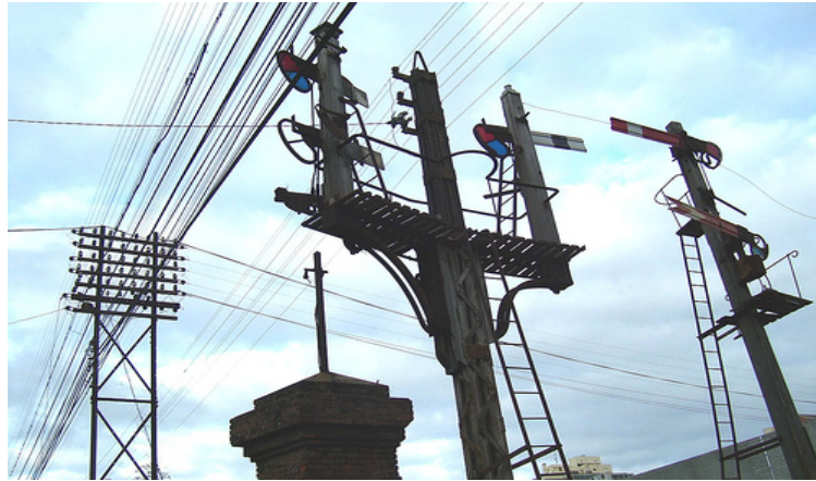
Figura 4.1.1 En la imagen se muestran las señales del tipo semáforo 2
