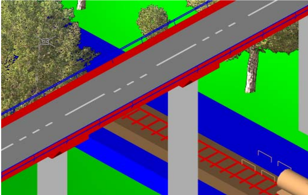
Fig. 5.13 Imagen donde se observa la carpeta asfáltica, muro deflector, parapeto metálico y acotamiento
