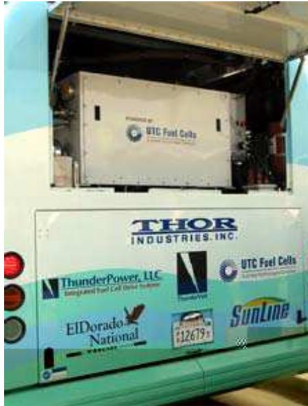
**Ilustración 23 Vehículo equipado con celdas de combustible para su propulsión**
