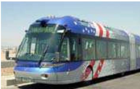
Ilustración 16 BRT VEHICULO ESPECIALIZADO ESTILIZADO ARTICULADO (CIVIS LAS VEGAS)
