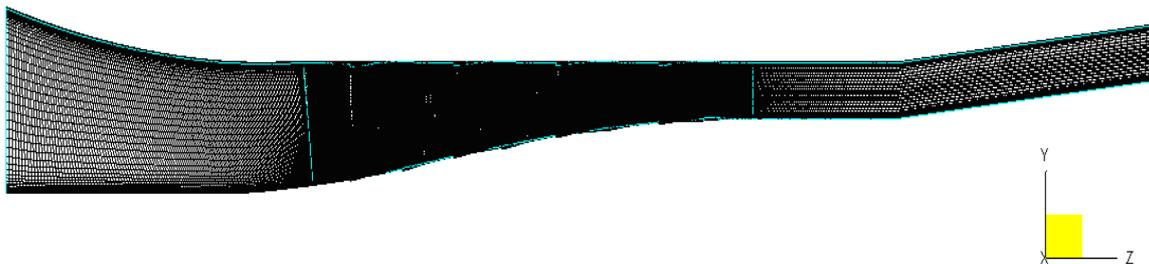
Fig. 3.8 Malla del compresor.
