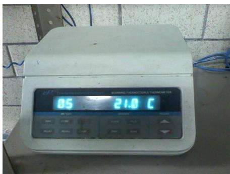
**Figura 14. Scanner marca Cole Parmer, modelo Thermocouple Thermometer utilizado para la lectura de temperaturas.**
