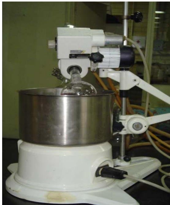
Figura 10. Sistema de destilación de Rotovapor
