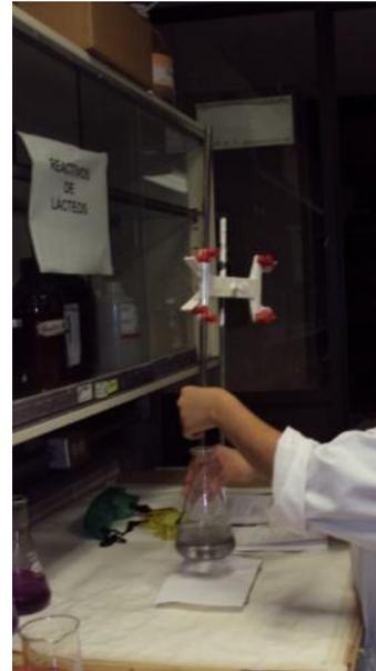
Figura 25. Titulación (determinación de la cantidad de nitrógeno en las muestras).
