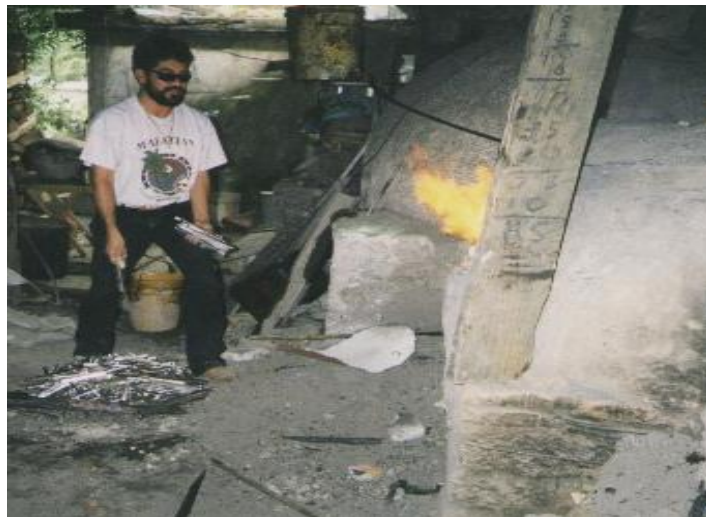
Figura No. 82. Fundición de cobre y estaño. Foto de la autora
