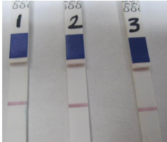
Figura 25. Tiras reactivas a la proteína Cry9, donde se muestra una banda única, demostrando la nula detección de esta proteína, siendo la tira 1. La muestra correspondiente a la cepa nativa de Y. lipolytica . Tira 2. Transformante Po1gBtCry1A(R), tira 3. Transformante Po1gTox1(I).
