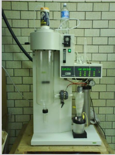
Figura 2. Secador por aspersión: Büchi B-290 (A), Mobile Minor Niro (B).
