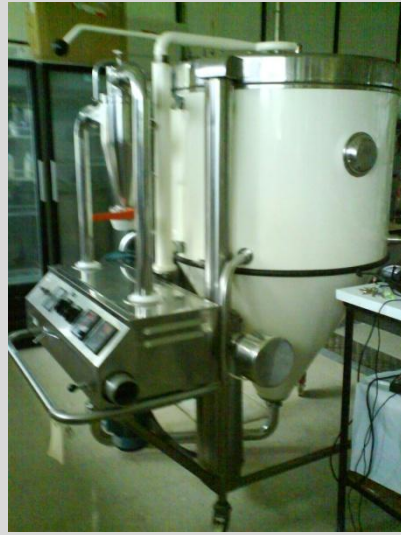
Figura 2. Secador por aspersión: Büchi B-290 (A), Mobile Minor Niro (B).
