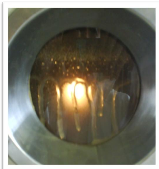
Figura 4.10. Problemas de escurrimiento de mucílago sobre la pared de la cámara de secado
