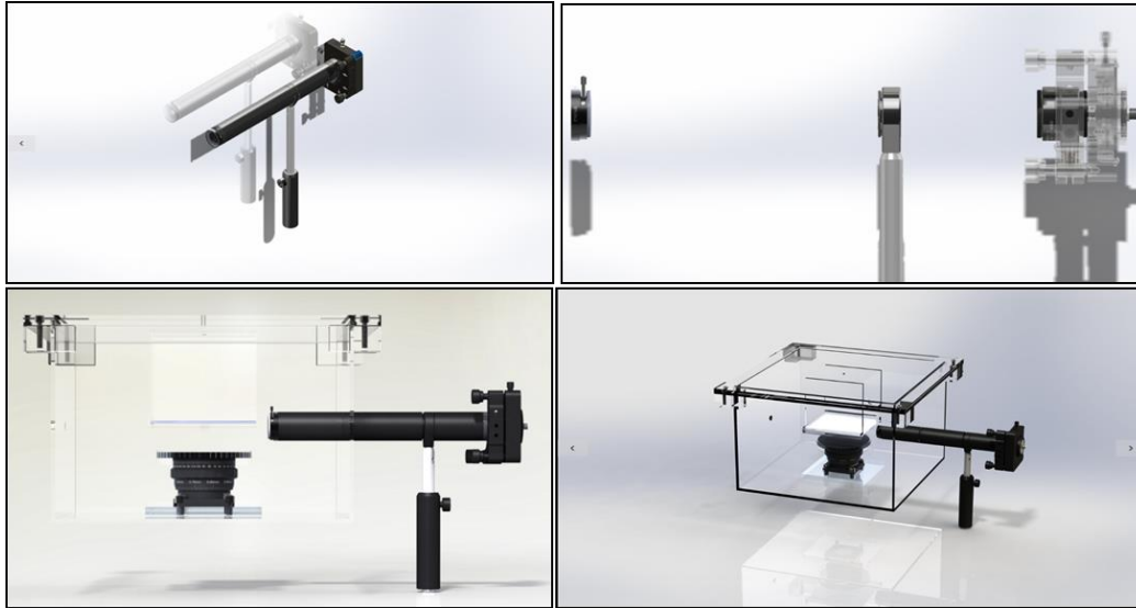
Figura B. 2 Simulación de montaje del aparato para medición óptica en diversas vistas y perspectivas ya montado en el sistema
