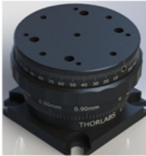
Figura 3-3. Dispositivo de desplazamiento vertical el cual provee una translación vertical que va de 2” a 3” con incrementos de 1mm/rev (1 \mu m)
