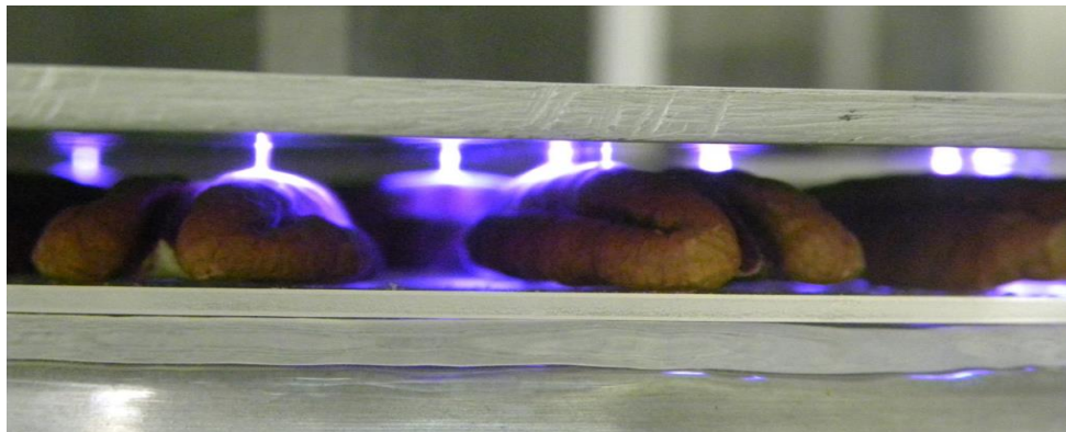
Figura A. 16. Exposición de nueces al plasma generado por el sistema.
