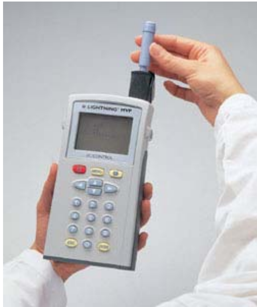
Figura 8: Luminometro utilizado para el monitoreo de equipos
