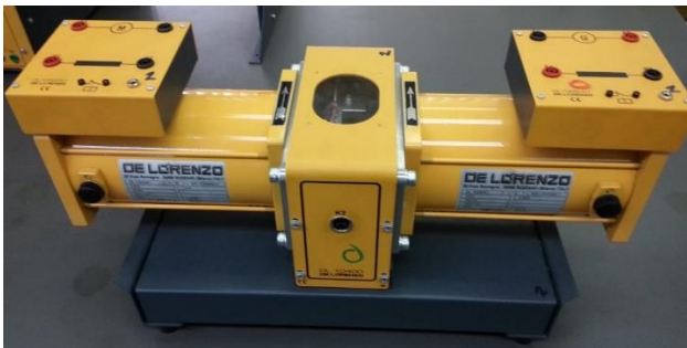
Figura 3.17 Acoplamiento mecánico Motor – Generador [25]
