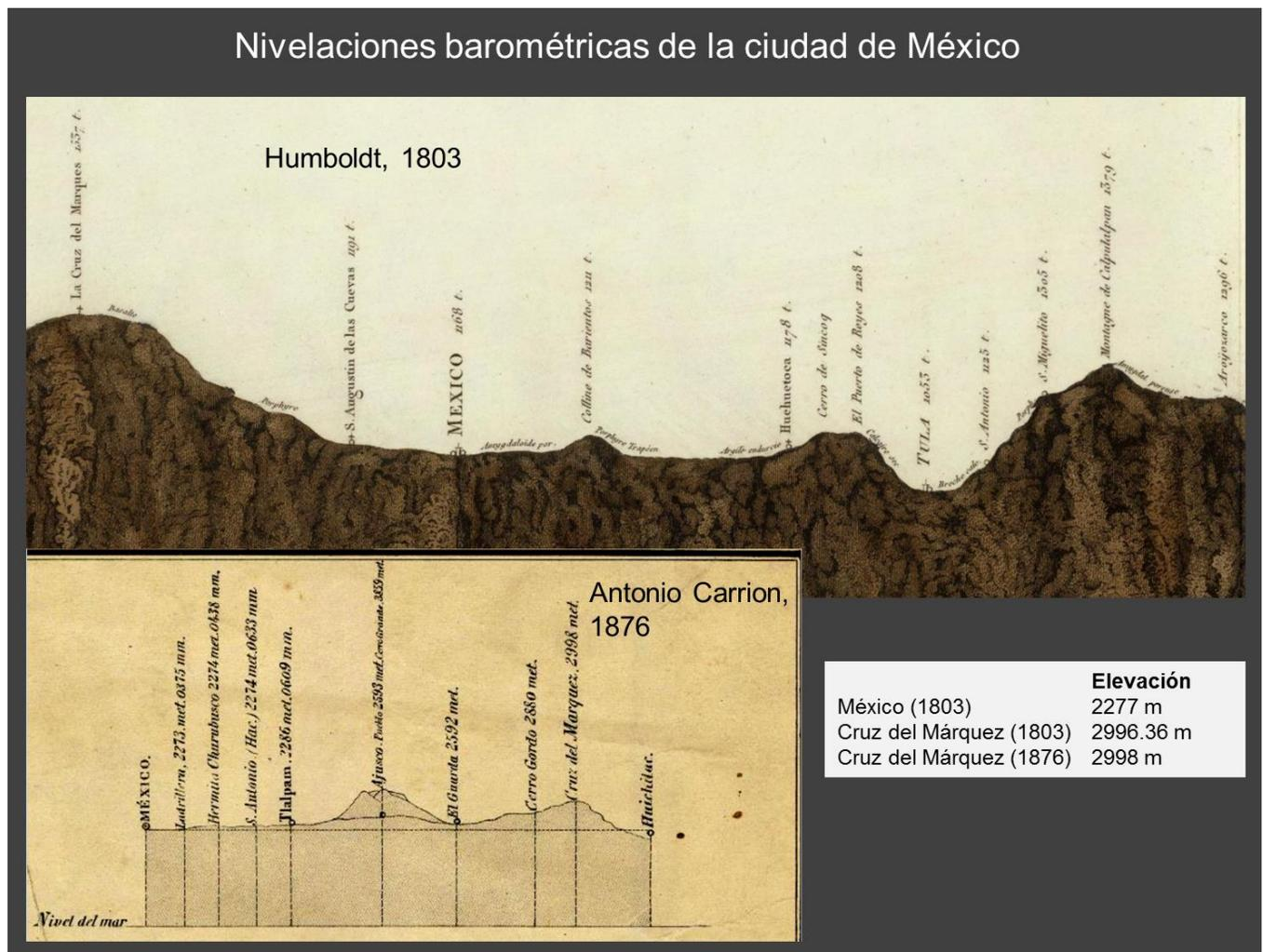
Fig. 1.3 Detalles de los perfiles de Humboldt, 1803 (arriba) y Antonio Carrión, 1876 (abajo) que muestran datos de nivelaciones barométricas
