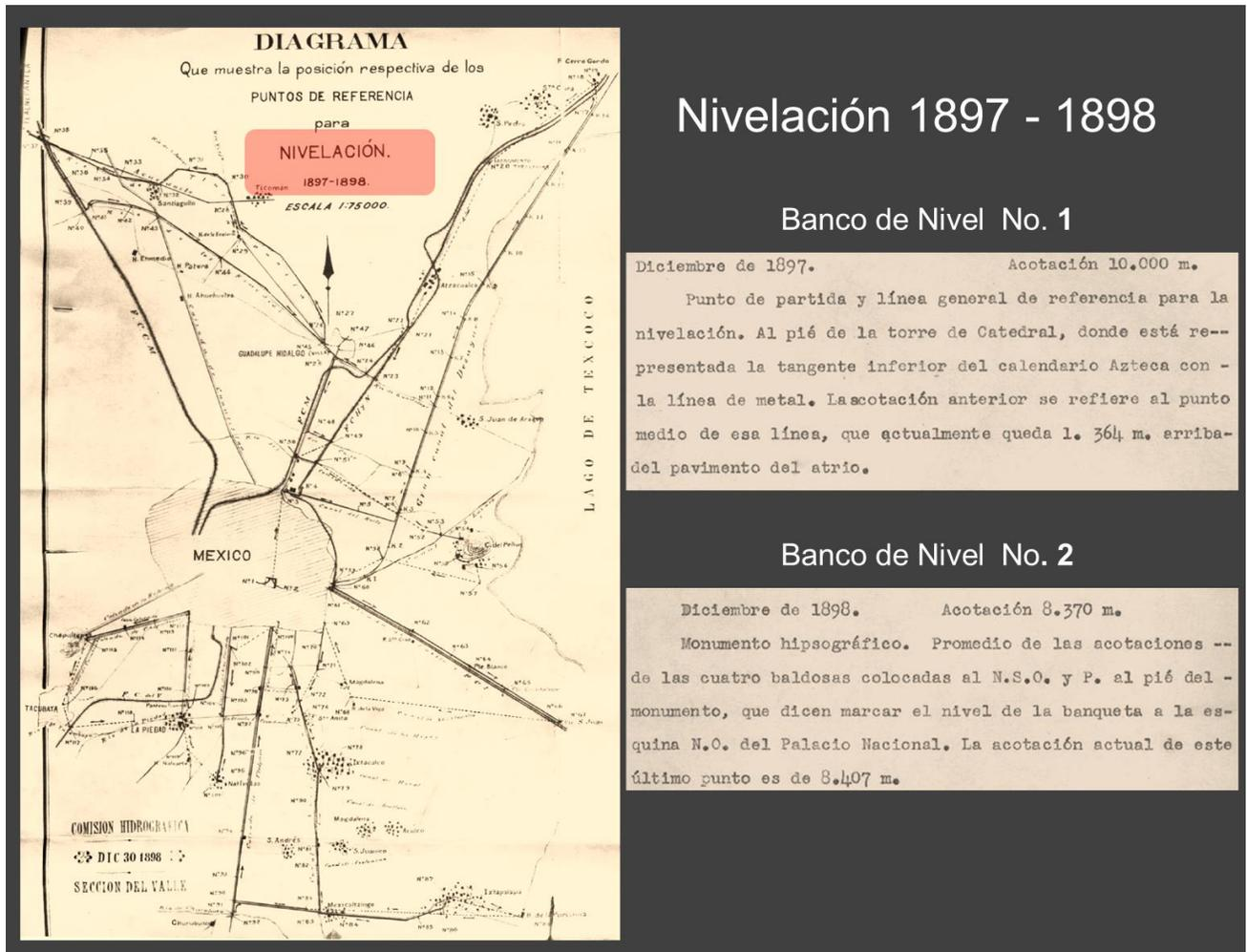
Fig. 4.14 Descripción de los Bancos No. 1 y 2 nivelados por la CH
