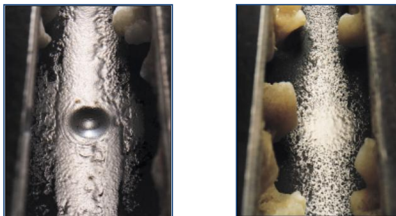
FIGURA 4.13. a) Tubería sometida a limpieza con abrasivos de partículas de vidrio. Las incrustaciones de carbonato fueron eliminadas. Durante el ensayo se mantuvo el chorro en la misma posición por espacio de 3 minutos y las partículas de vidrio cortaron un agujero hasta una profundidad de casi un 30% de la pared del tubo. b) Incrustaciones eliminadas con el abrasivo
