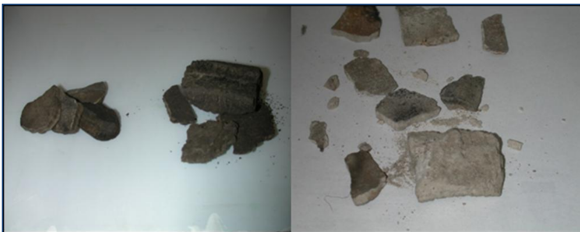
FIGURA 3.5. Muestra incrustante del pozo Sihil 8, antes y después del lavado
