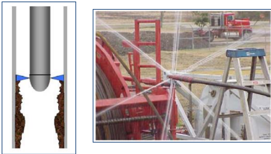
FIGURA 4.11. Esquema del funcionamiento de la herramienta de chorro de fluidos.
