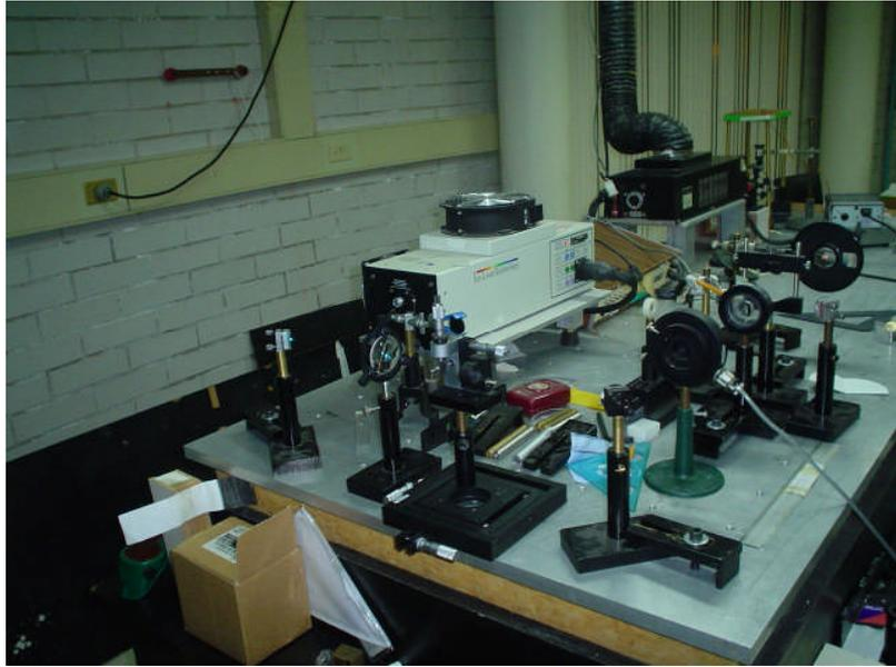
**Figura 3.19** Fotografía del montaje experimental para la medición de la cintura del láser.
