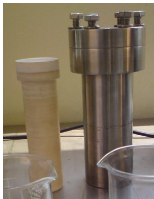
Figura B2. Camisa de teflón y autoclave utilizados en las diferentes reacciones.
