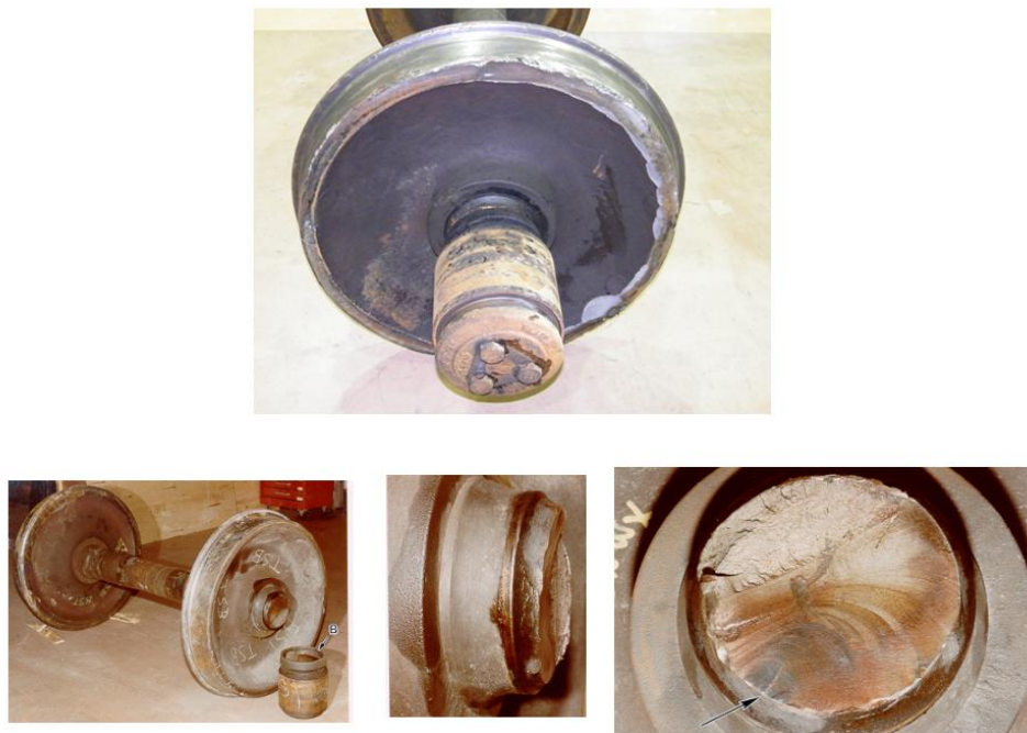
Figura 1.12. Falla por fatiga en eje de ferrocarril [85]
