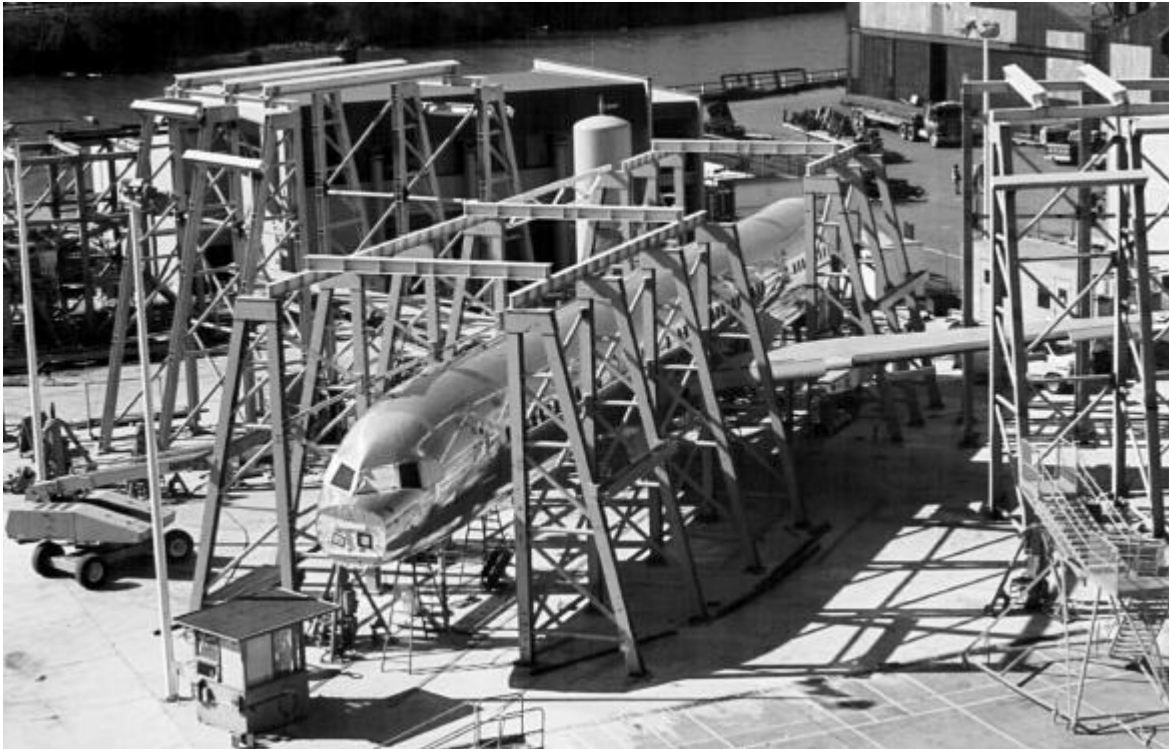
Figura 1.6. Dispositivo de prueba a la fatiga del Boeing 757 para ensambles de ala y fuselaje [82].
