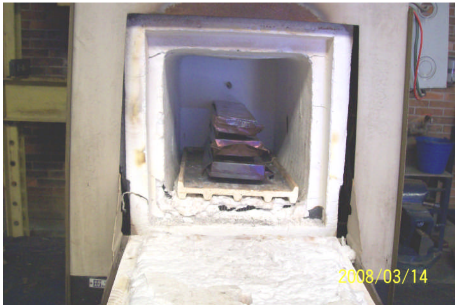
Figura IV.5.- Paquetes de vigas después del tratamiento térmico
