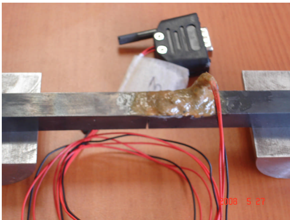
Figura IV.8.- Implementación y recubrimiento de galga extensométrica en la probeta
