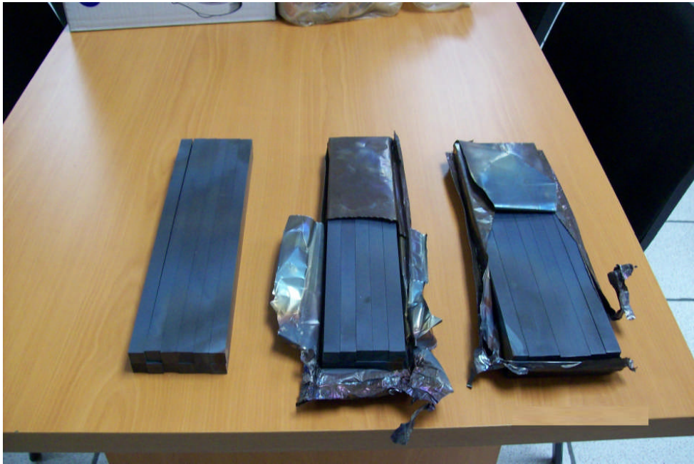
Figura IV.6.- Vigas después del recocido por relevado de esfuerzos
