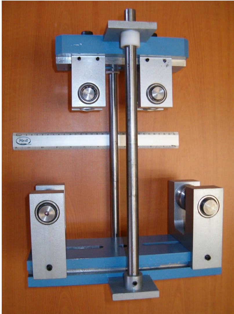
Figura IV.7.- Banco de trabajo para pruebas de cuatro puntos de flexión
