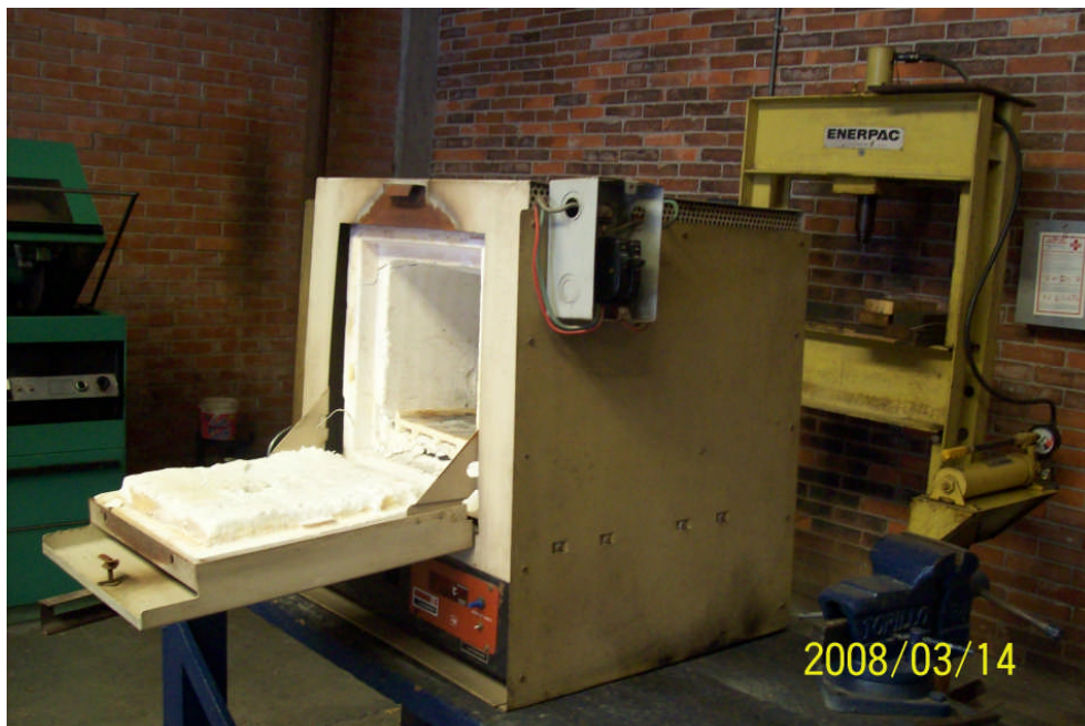
Figura IV.4.- Horno empleado para tratamiento térmico
