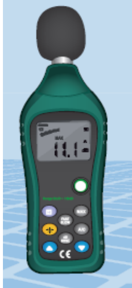
Figura 3.12 Sonómetro HER-402 Steren empleado en la toma de niveles de intensidad sonora.
