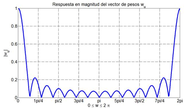
Figura 2. Respuesta en magnitud normalizada  $|\mathbf{W}(e^{j\omega})|$
