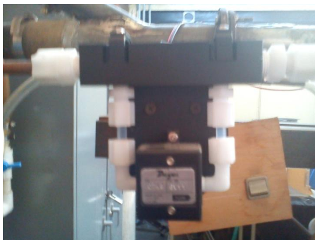
Figura 2.8 Rotámetro tipo turbina para medición de flujo de gas
