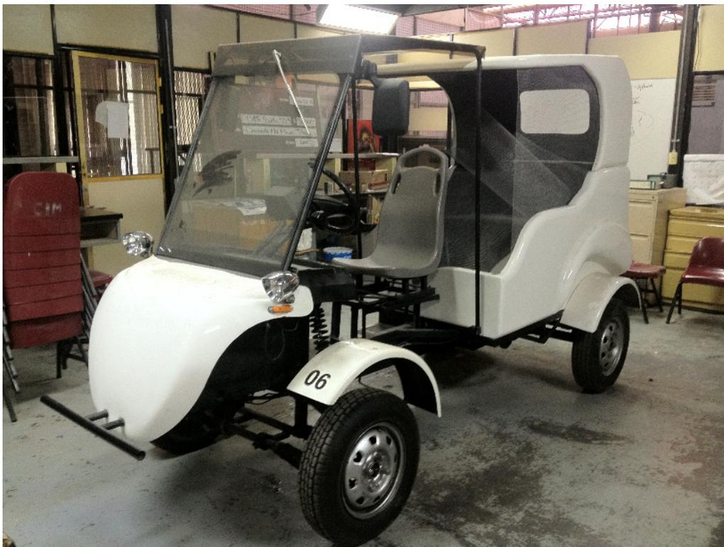
Figura 4. 7. Carrocería del VE [26].
