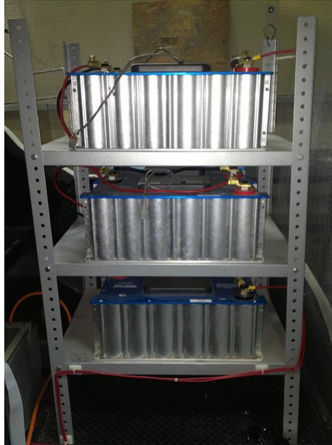
Figura 4. 36. Módulo de *SCs* Montado en el VE.
