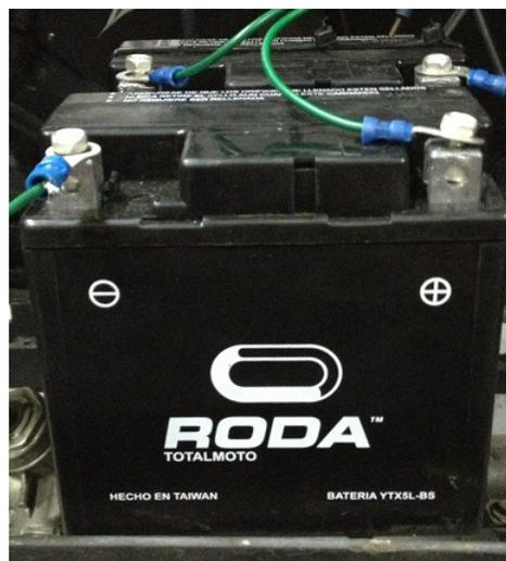
Figura 4. 31. Baterías RODA de 12 VCD.
