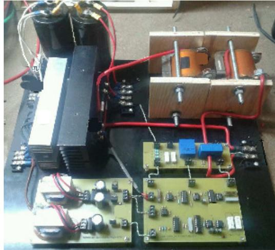
Figura 4. 6. Cargador de Supercapacitores [21].
