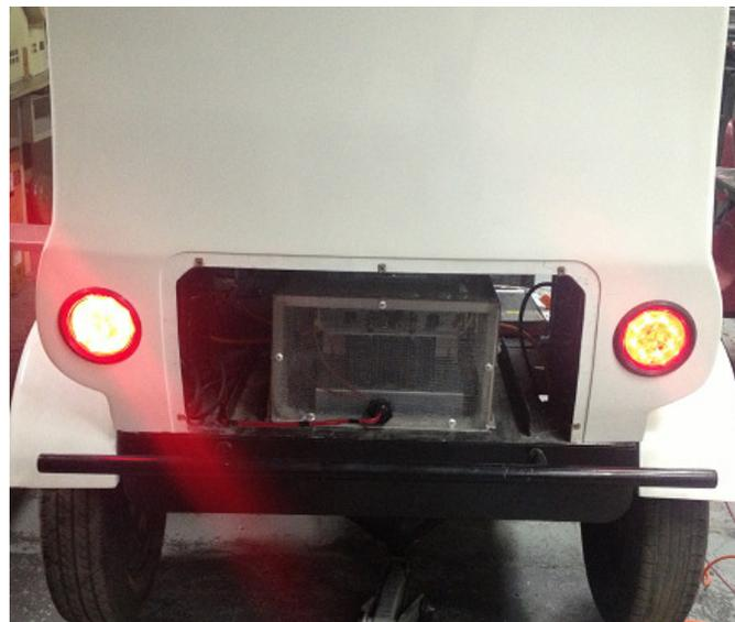
Figura 4. 37. Montaje del Inversor en el VE.
