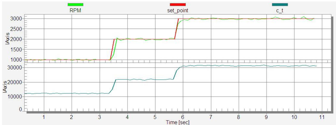
Figura 4.7: Control en cascada donde las constantes del PID tienen valores de 2.00 (proporcional), 5.00 (integral) y 0.05 (derivativa)
