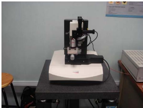
Figura 3.7 Nanoindentador TTX-NHT, CSM Instruments (Centro de Nanociencias y Micro y Nanotecnología, del Instituto Politécnico Nacional).
