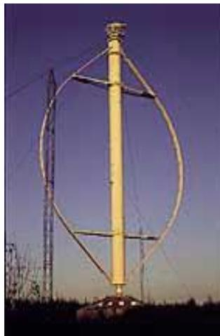
Figura 1.13 Aerogenerador de eje vertical tipo Darrieux de 1.5 MW
