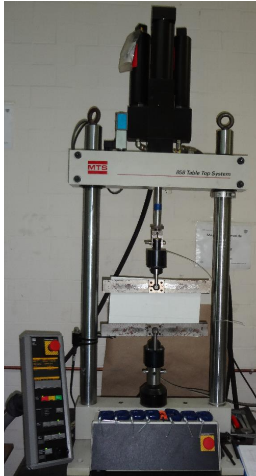
Figura 4.4. Montaje de la probeta en la MTS 858 Table Top System
