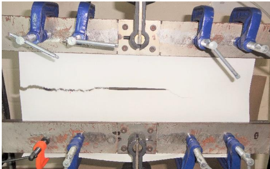
Figura 4.7. Fractura de la probeta de poro abierto de dimensiones 400x100 mm
