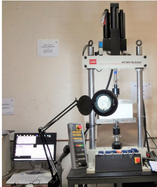
Figura 4.5. Búsqueda del lugar de inicio de propagación de grieta con ayuda del flexo con lupa y luz
