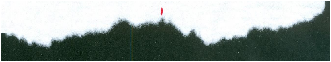
Figura 4.8. Imagen de la línea de ruptura obtenida con el escáner de alta resolución en donde se muestra con una marca roja el inicio de la propagación inestable de la grieta
