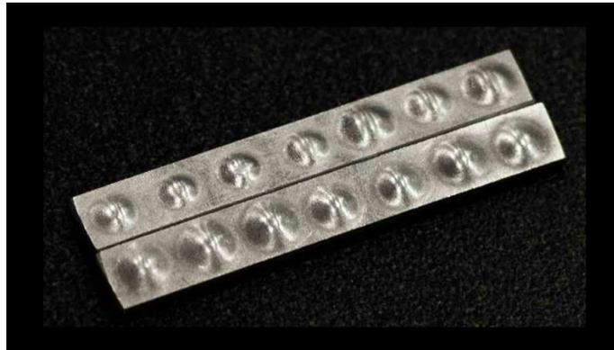
**Figura 12: Envoltorio metálico de burbujas (Martínez et al 2010)**
