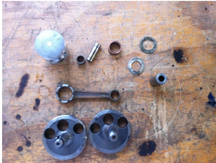
Figura 3.14. Componentes de un motor de motocicleta Yamaha.
