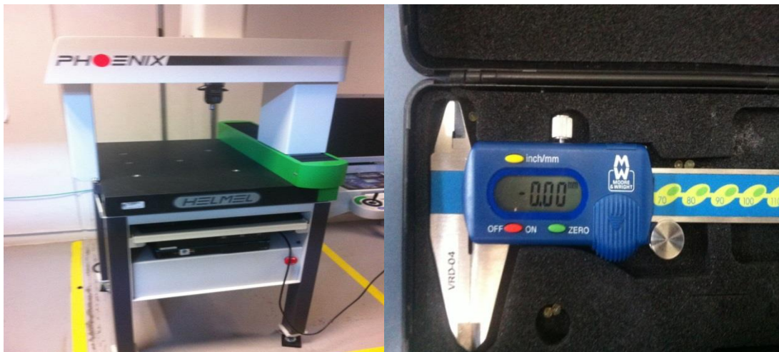
Figuras 3.15. Equipo de medición utilizado en el presente proyecto. Del lado izquierdo de la imagen se muestra la máquina de coordenadas y del lado derecho se muestra el Vernier.
