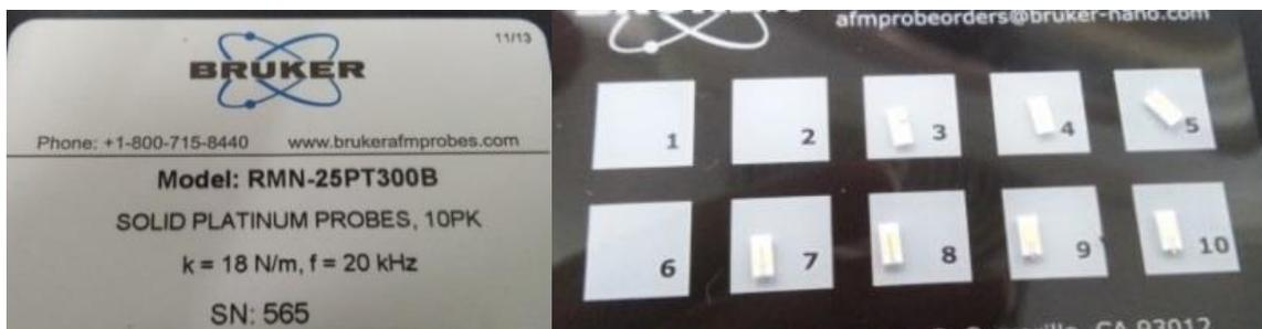
**Figura 4.12.** Sondas de platino para AFM.
