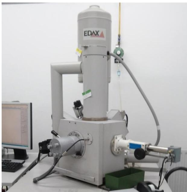
**Figura 4.9.** SEM/EDS marca EDAX modelo Quanta 200 con capacidad hasta para 7 muestras de los CCiT de la Universitat de Barcelona.
