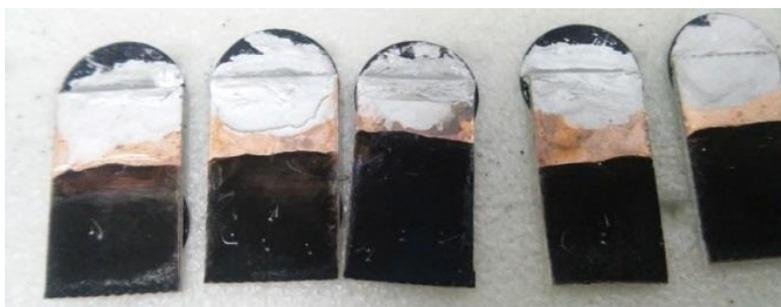
**Figura 4.4.** Serie de muestras de  $\text{CuInSe}_2$  sin dopar y dopadas con Li, Na, K y Cs al 1% en la solución electrolítica (de izquierda a derecha respectivamente).
