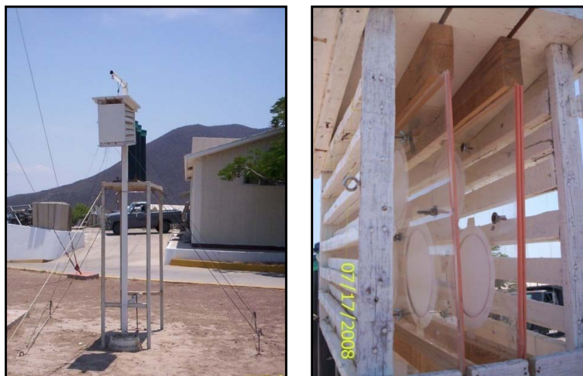
Figura 10. Caseta para la recolecta de muestras para el análisis de depositación seca de N en el área de estudio.
