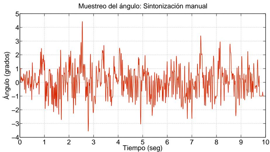
Figura 4.8: Controlador difuso: Sintonización manual
