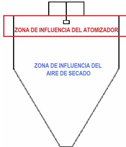
Fig. 17. Esquema de las zonas de influencia sobre el movimiento de la gota dentro de la cámara de secado.
