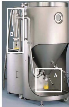
Fig. 7. Recuperación del producto en el secador por aspersión (GEA Process Engineering, 2008): A) Separación primaria, B) Separación secundaria.
