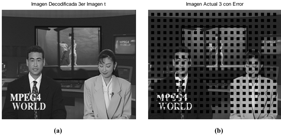
Figura 5.30. Imagen decodificada de News (a) sin errores (b) con distribución de error en forma uniforme con MB's de tamaño 8x8.
