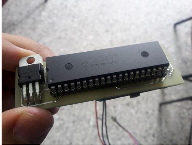
*Fig. 4.18 Parte superior del medidor de ritmo cardiaco*
