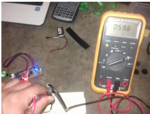
*Fig. 4.21 Consumo de corriente 59.6 mAh*
