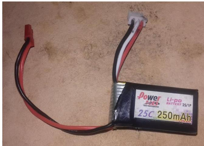
*Fig. 3.13 Bateria Li-po para el suministro eléctrico del circuito*
