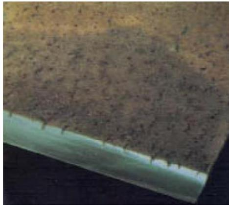
Figura 11. Crecimiento de grietas transversales por ciclos térmicos
