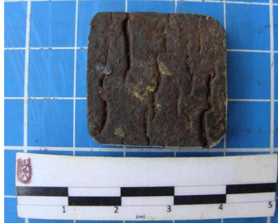
Figura 27. Sección del área dañada después de limpieza
