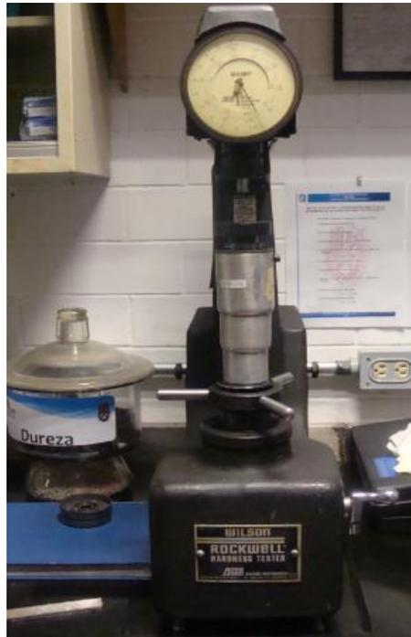
Figura 31. Durómetro Rockwell utilizado para la prueba de dureza HRB.
