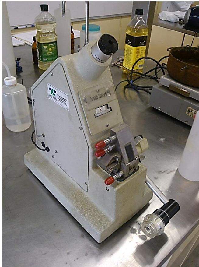
Figura 44. Refractómetro de ABBE.
