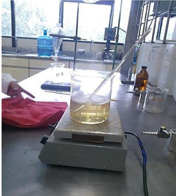
**Figura 30.** Adición de agua destilada caliente hasta formar el jabón (Hidrólisis).
