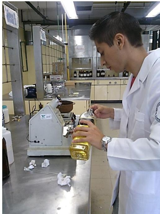
**Figura 46. Colocación de la muestra para lectura en el refractómetro ABBE.**
