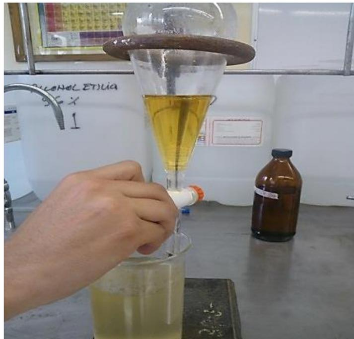
**Figura 37. Lavados con agua destilada caliente.**
