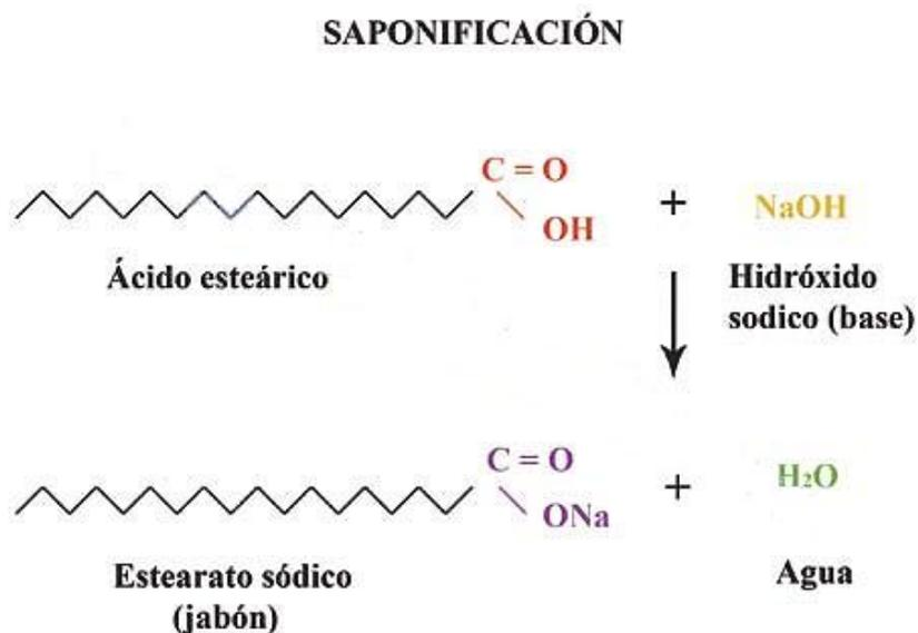
Figura 16. Ejemplo de la reacción de saponificación.
