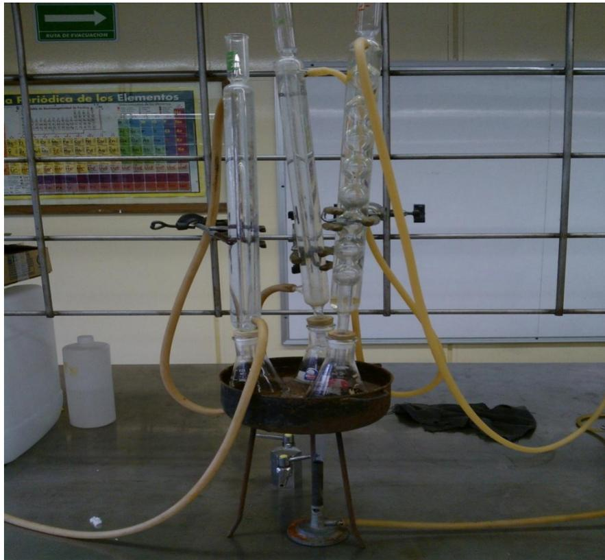
**Figura 41. Montaje del equipo para saponificación.**
