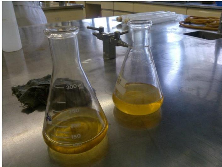
**Figura 40. Solución de hidróxido de potasio con el aceite vegetal para la determinación del índice de saponificación.**
