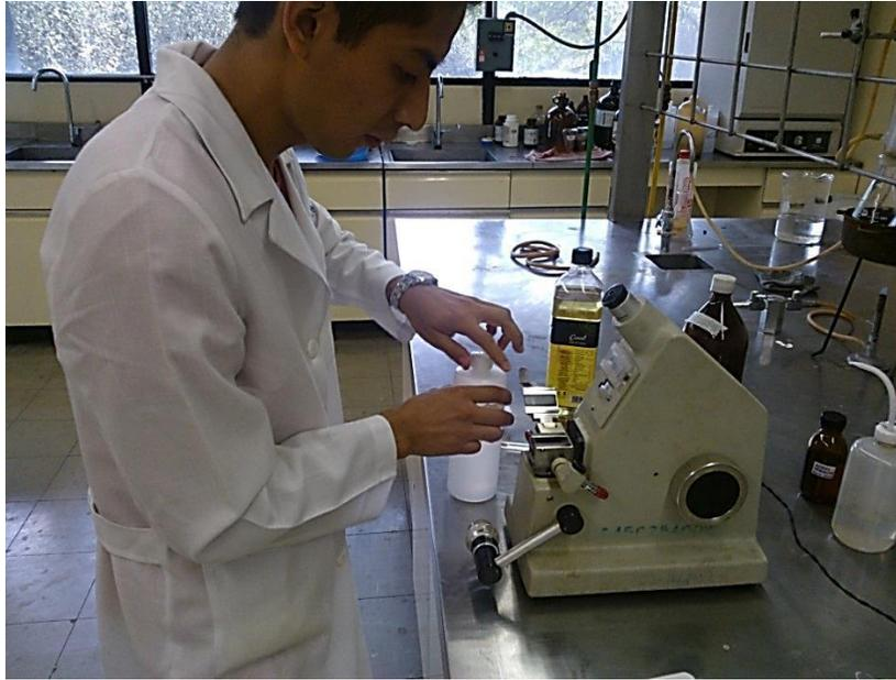
**Figura 45. Limpieza del refractómetro de ABBE con solvente.**
