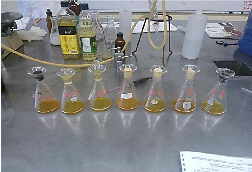
**Figura 41. Preparación de las muestras y del testigo para la determinación del índice de yodo.**
