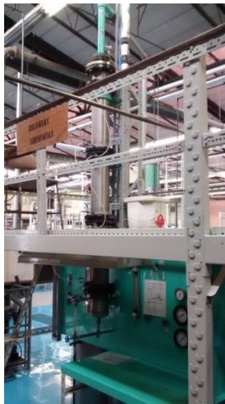
Figura 3.1. Columna de absorción empacada del Laboratorio de Operaciones Unitarias, ESIQIE-IPN.
