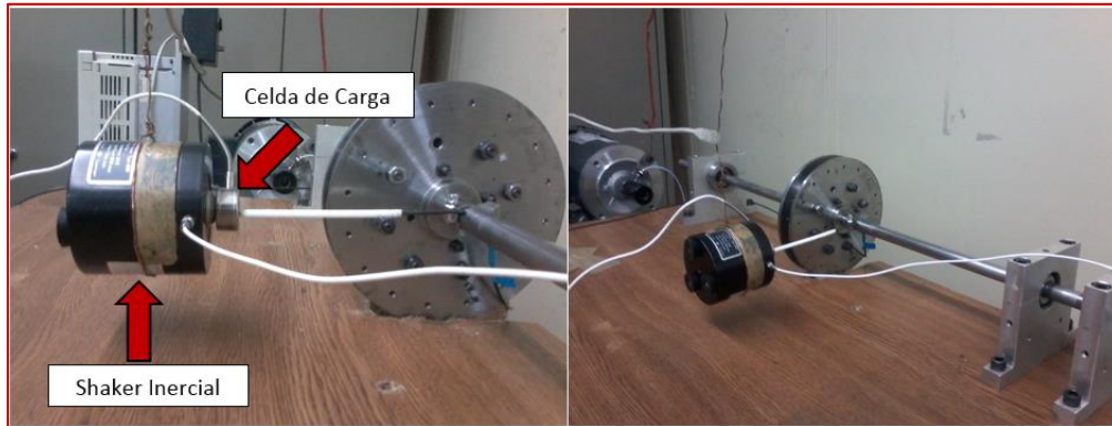
Figura 9.7 Conexión de Sensor de Carga y Shaker Inercial.
