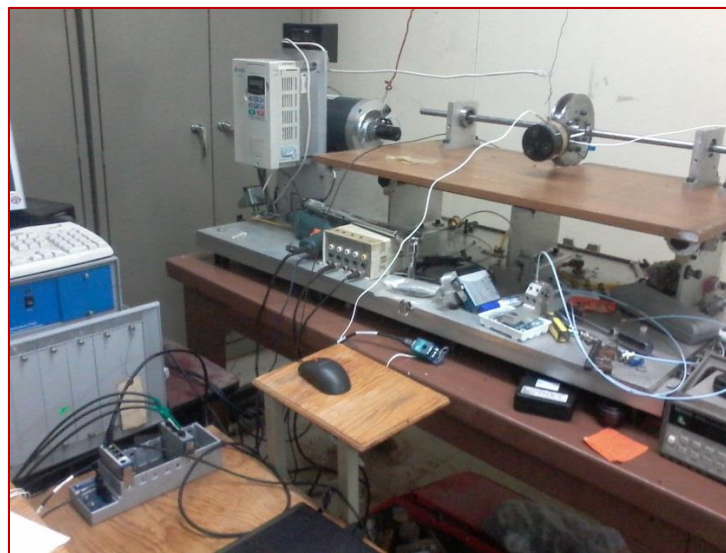
Figura 9.8 Set de experimentación final para el cálculo de FRF con celda de Carga y Shaker inercial.
