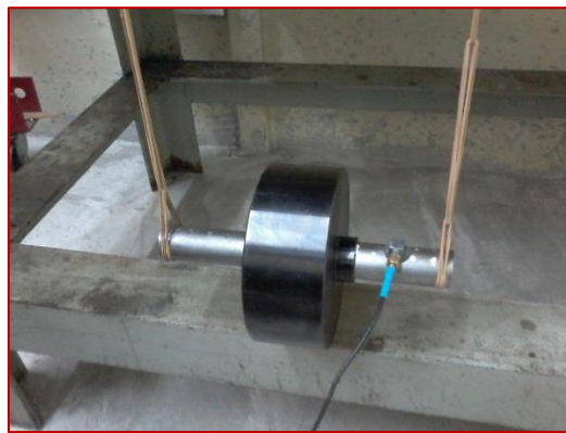
Figura 5.23 Foto de configuración experimental utilizada en mediciones para el eje de acero con L/D=8 integro y fisurados en condición Libre-Libre, con disco montado.
