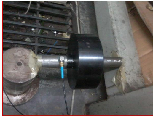
Figura 5.32 Foto de configuración experimental utilizada en mediciones para el eje de acero con L/D=8 íntegro y fisurado en condición Simplemente Apoyado, con disco montado.
