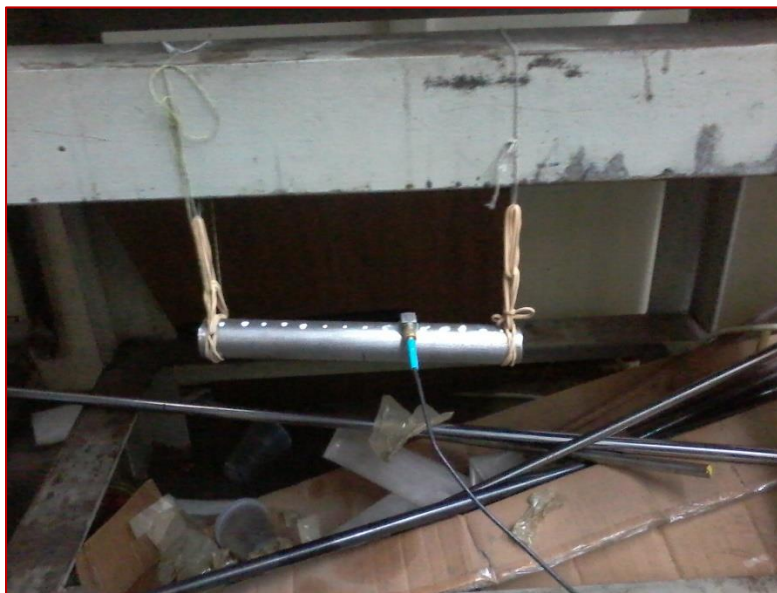
Figura 5.14 Foto de configuración experimental utilizada en mediciones para el eje de acero con L/D=8 integro y fisurados en condiciones Libre-Libre, sin disco montado.
