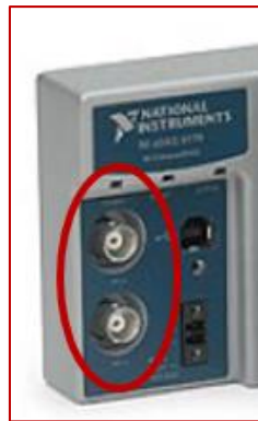
Figura 4.21 canales PFI 0 y PFI 1 del Chasis NI CompactDAQ USB Data Acquisition Systems-9178
