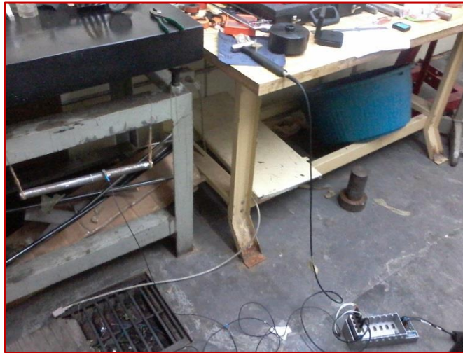
Figura 5.1 Foto de configuración experimental utilizada en mediciones para el eje de acero con L/D=24 íntegro y fisurados en condiciones Libre-Libre, sin disco montado.
