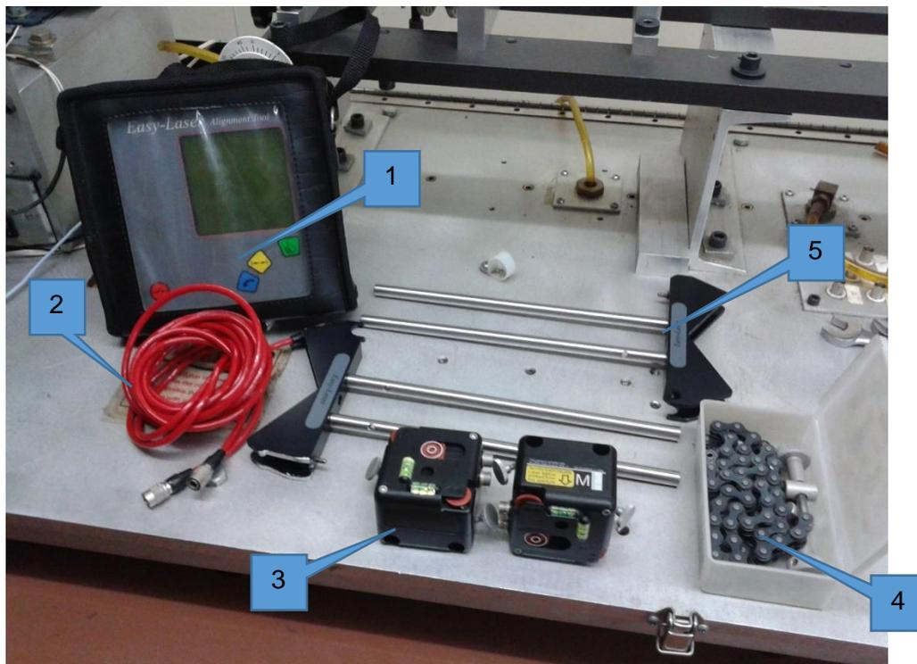
Fig. 4.5 Partes del sistema de alineación láser
