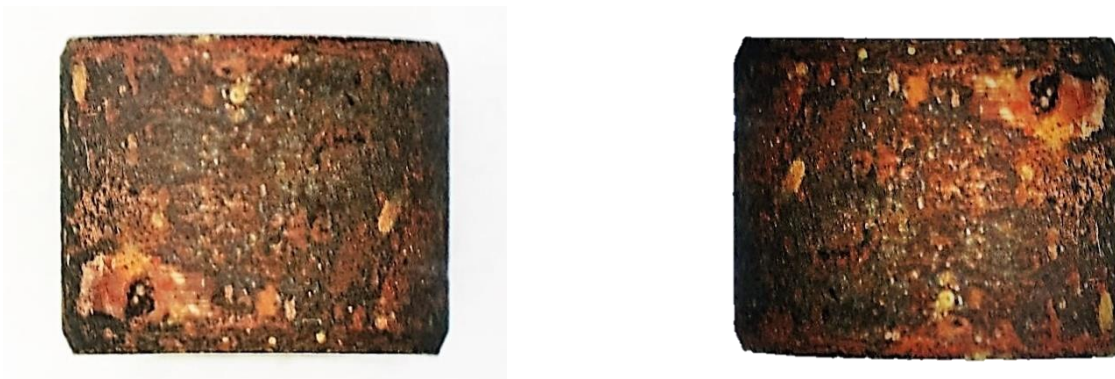
Figura 3.5 Productos de corrosión formados en la probeta a un bar de \text{H}_2\text{S} a 60^\circ\text{C} .
