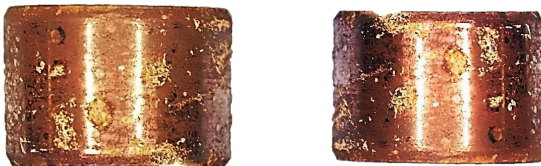
Figura 3.7 Productos de corrosión formados en el acero a un bar de \text{CO}_2 a 60^\circ\text{C} .
