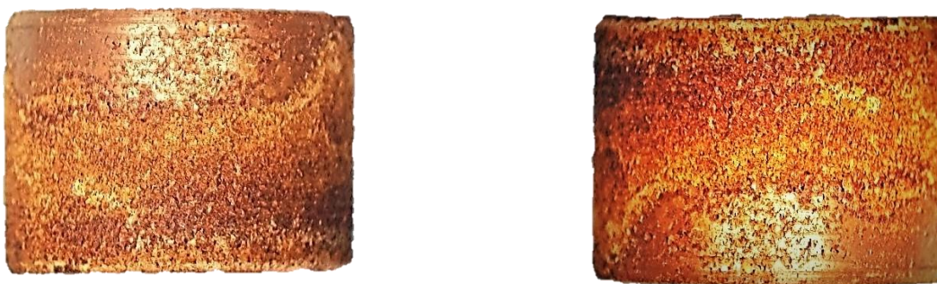
Figura 3.6 Productos de corrosión formados en el acero a un bar de \text{CO}_2 a 30^\circ\text{C} .
