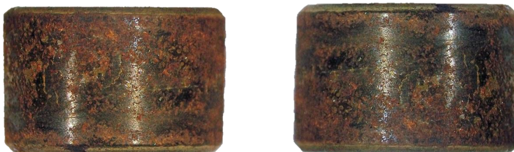
Figura 3.4 Productos de corrosión formados en la probeta a un bar de H_2S a 30^\circ C .
