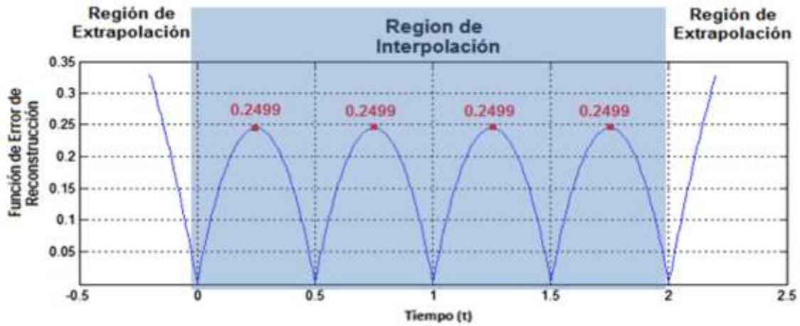
Figura 2-14 Función de Error de reconstrucción de procesos Gaussianos Markovianos  $\Delta T = 0.5s$ ,  $N=5$ .
