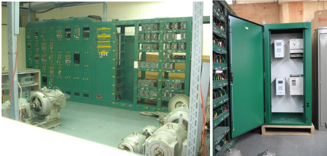
a) Micro red con máquinas síncronas de polos lisos y salientes de 4.5 kVA.
