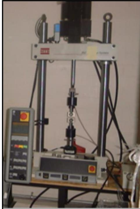
***Fig. 3.13 Máquina de ensayos universal MTS -858.***
