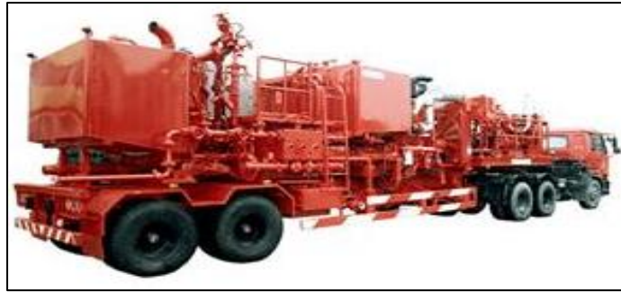
Figura 28. Unidad de alta presión en tierra.
