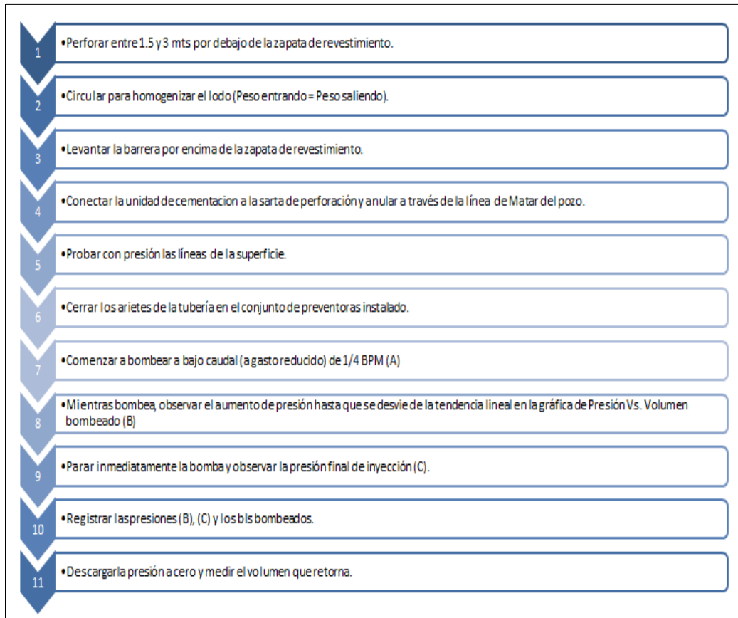
Figura 24. Procedimiento para una prueba de goteo.
