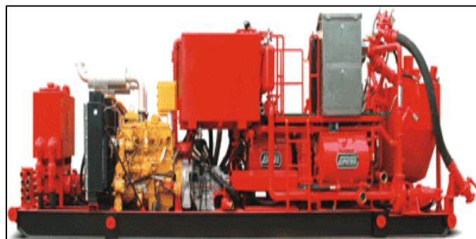
Figura 27. Unidad de alta presión utilizada en plataformas marinas.
