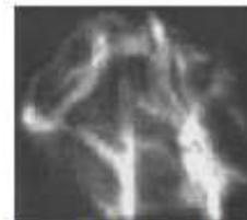
Fig. 4. Impresión típica de un haz de luz láser propagándose a través de un medio turbulento
