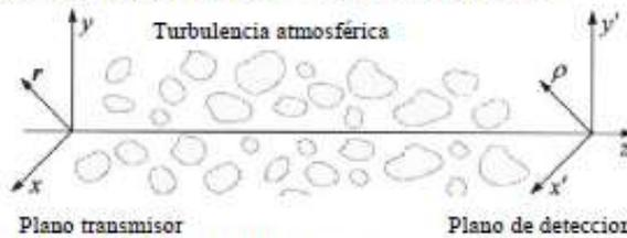
Figura 3 geometría de propagación
