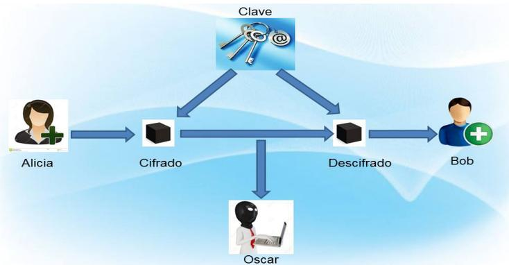
Figura 2.1: Diagrama cifrado simétrico
