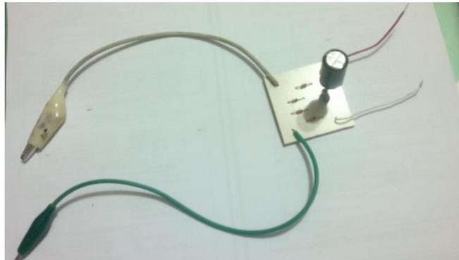
*Figura 31. Circuito cosechador de energía.*
