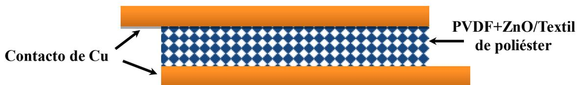
**Figura 24.** Diagrama esquemático del dispositivo generador de energía a partir del textil con una película PVDF con nanopartículas de ZnO.
