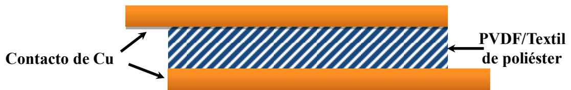
**Figura 23.** Diagrama esquemático del dispositivo generador de energía a partir de PVDF/Textil.
