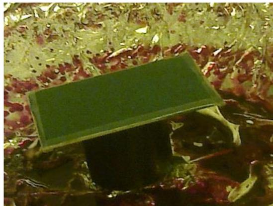
*Figura 21. Sustrato textil colocado en el Chuck (parte interna del equipo de recubrimiento por rotación).*
