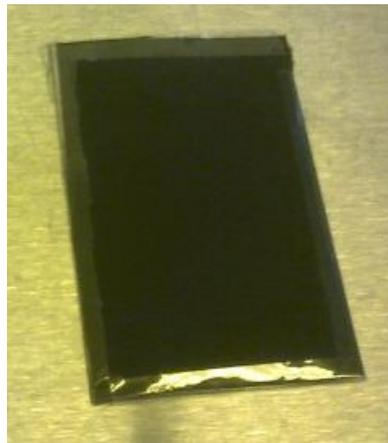
*Figura 20. Sustrato textil fijado a la placa de vidrio.*
