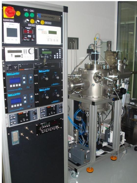
**Figura 22 .** *Equipo de pulverización catódica (Sputtering) instalado en el Centro Nacional de Micro y Nanotecnología (CNMN).*
