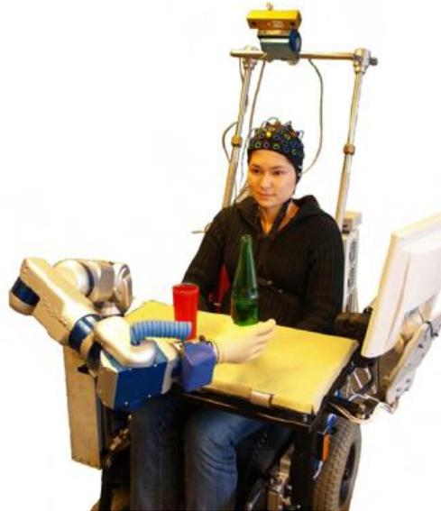
Fig. 8 Friend II Sistema controlado por una ICC [27]
