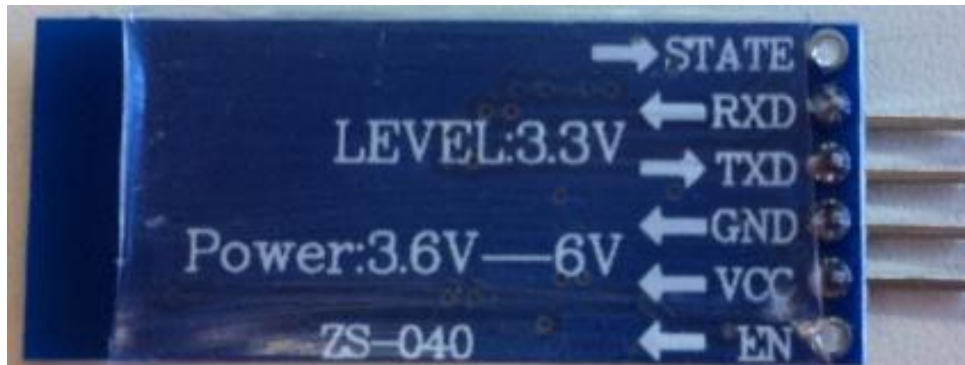
Figura 3.11 Señalización de las patas del módulo HC-06
